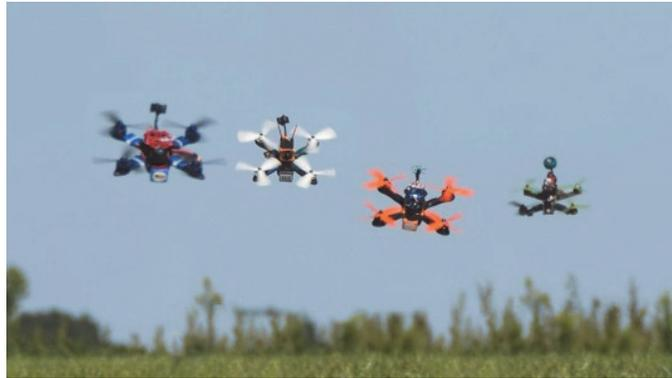
В дрон-рейсинге существует ограничение: расстояние между роторами диаметрально противоположных моторов не должно превышать установленное значение. Наиболее популярные классы дронов – от 210 до 250 мм. Количество моторов обычно не регламентируется, но почти все пилоты летают на квадрокоптерах: это оптимальное решение с точки зрения мощности, веса и аэродинамики. Моторы устанавливаются помощнее. При этом время полёта гоночных дронов невелико и в среднем составляет 3–5 мин.
